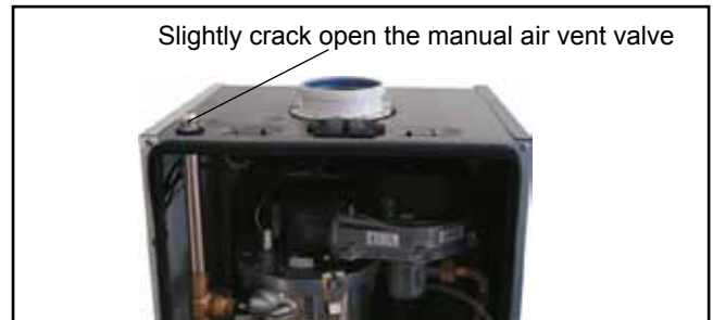
Fig.: Manual air vent valve
