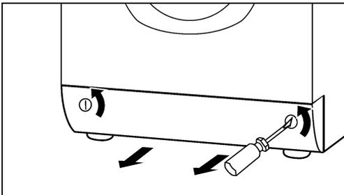
3. Faites sortir le tuyau de vidange, retirez-en le bouchon de fermeture, laissez l'eau s'écouler dans le panneau du socle. Répétez l'opération plusieurs fois si nécessaire.
