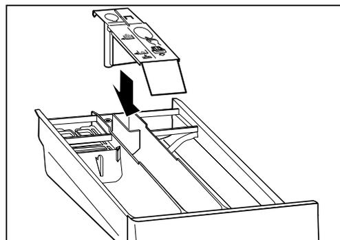
6. Replacez le bac à lessive dans l'appareil.
