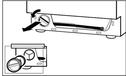
6. Enlevez corps étrangers et dépôts de peluches. Nettoyez l'intérieur de la pompe. Les ailettes de celle-ci doivent pouvoir tourner.
